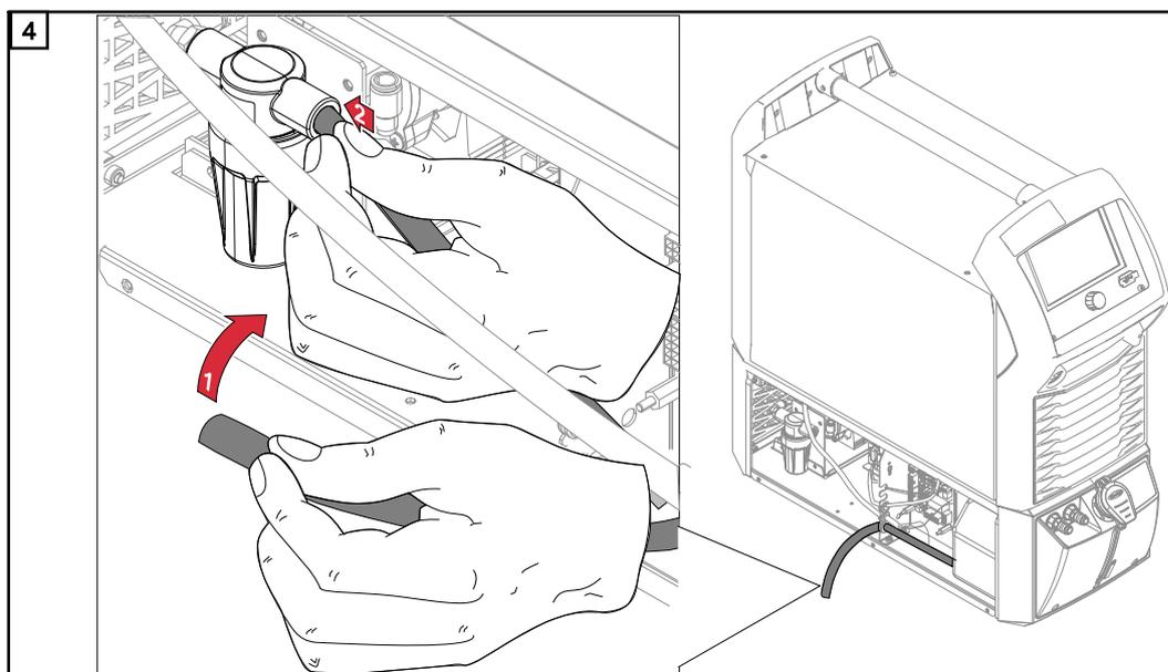
Вставьте шланг для подачи охлаждающей жидкости в фильтр предварительной очистки охлаждающей жидкости.
